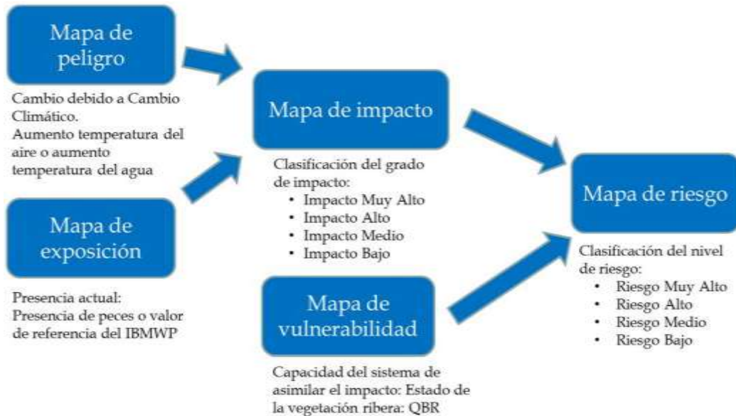
Figura 21. Esquema de la metodología propuesta para la determinación del riesgo asociado al cambio climático
